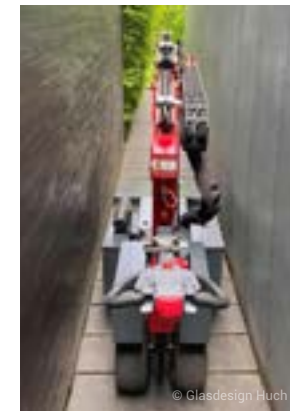
Kranspitze für Lasten bis 250 kg
