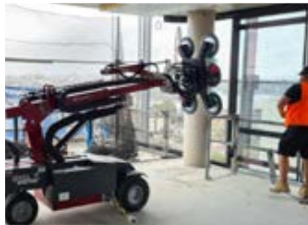
Der GW625-2 ist weltweit im Einsatz zur Montage von Fassadenelementen
